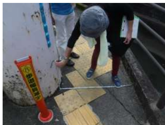
歩道の幅員の確認
